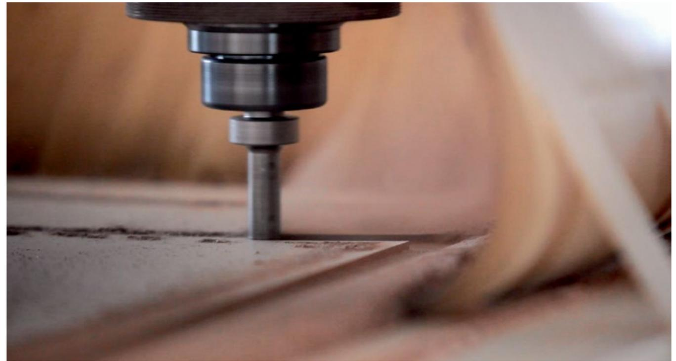
Taglio, forature e incisioni sul pannello. G&D ha più macchinari dedicati alla pantografatura, programmabili in tempo rapidissimi e capaci di importare direttamente i file di progettazione. Avete un file autocad? Inviatelo a G&D e le vostre istruzioni saranno rispettate al millimetro.
